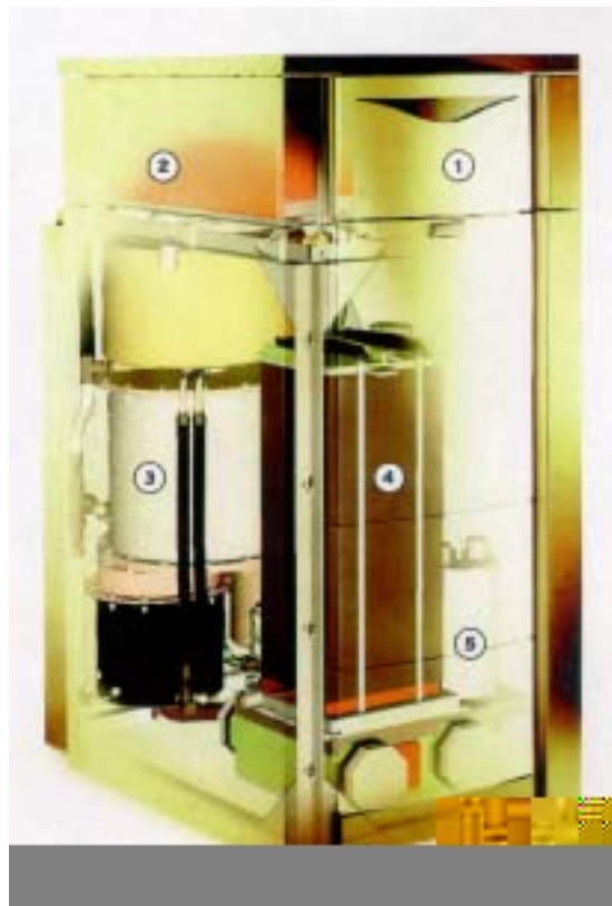
Abbildung 6: Brennstoffzellen-Heizsystem von Vaillant (PEM). 1: Regler und Kommunikationsschnittstelle, 2: Wechselrichter, 3: Reformier, 4: Membran-Brennstoffzellenstack PEFC, 5: Wärmerückgewinnung.
